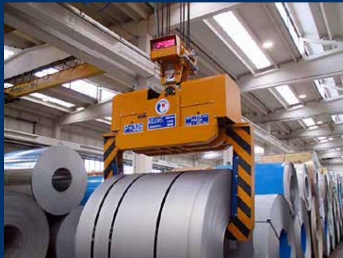
Pinza per coils Mod. 204 + sistema di pesatura Grab Mod. 204 + weighing device Pinza portabobinas Mod. 204 + sistema de control del peso
