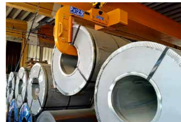
Gancio a C + rotazione Mod. 152 C hook + rotation device Mod. 152 Pinza portabobinas + rotación Mod. 152
